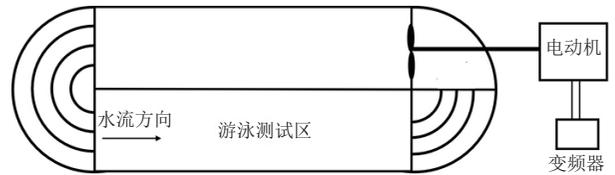
图 1 游泳能力测试水槽
