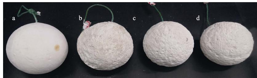
图 2 石膏球水中暴露实验前后对比
